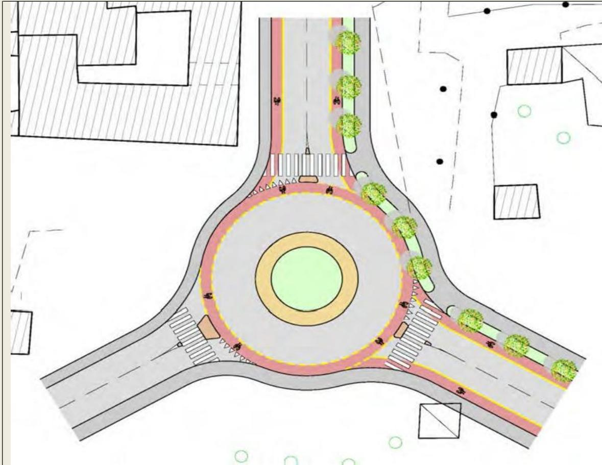
*Esempio di inserimento di una pista ciclabile monodirezionale in una rotatoria con diametro di 28 metri: la corsia ciclabile può essere riportata direttamente in corona, senza tuttavia allargare la sede carrabile; tale indicazione infatti riveste sostanzialmente il significato di sottolineatura della presenza ciclabile e di segno di continuità dei percorsi*
